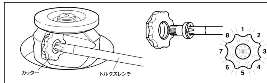
※出荷時は、刃の最良の位置にてフランジを固定しております。高さを変える場合、フランジが動きづらいことがあると思いますが、それは振動で動かないように初めから固い設定になっております。強めに回していただきますと、高さは変えられます。
