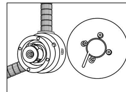
3. カッターホルダーに装着されている3個のカッター刃のスクリューを緩め、8面ある面をそれぞれ位置を合わせてください。
