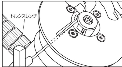
3.カッターホルダーに装着されている3個のカッター刃のスクリューを緩め、8面ある面を同じ位置に合わせてください。
