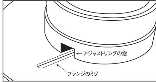
2.ツールを裏返しにし、フランジのミゾと窓に沿ってトルクスレンチをカッター刃のスクリューに目掛けて差し込んでください。
