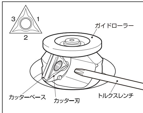
2. セットしたカッターベースにカッター刃を取り付け、トルクスレンチでカッターholderにしっかりと固定してください。
