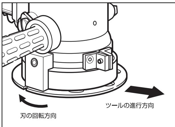
3. 刃の回転(右回転)と同方向(矢印方向)にツールを動かしてください。
