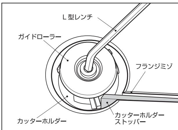
1. カッターholderストッパーをフランジミゾにはめ込み、カッターholderがまわらないように固定し、ガイドローラーをHex.レンチで外し、カッター刃全体を露出させてください。
