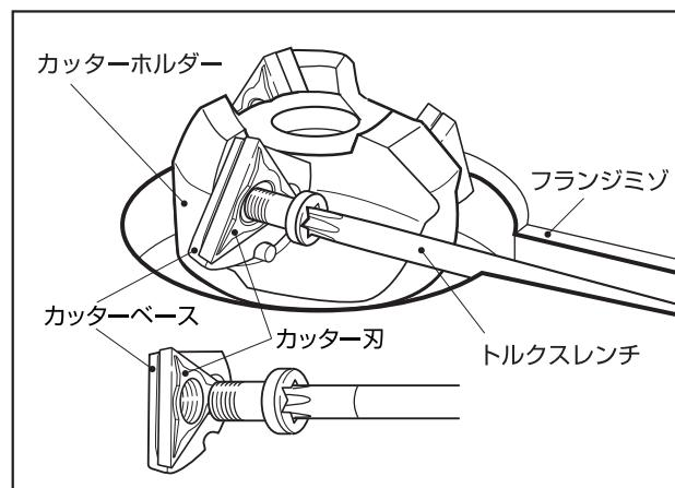
2. トルクスレンチでカッター刃のネジを外して、3個の刃を取り出し、交換してください。
